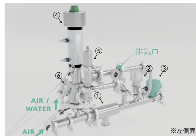
①ランチャーステーション(CIP回路あり) ②排気弁 ③センサー ④トランスRバルブ4WAY※ ⑤背圧調整バルブ ⑥原料逆止弁 ※アクチュエーター生産終了に伴い、トランスRバルブ(オート)4・5WAYは在庫限りとなります。ハンドタイプは引き続き製作可能です。
